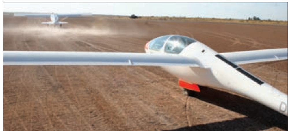
Starthilfe: Die aufgrund ihrer Kurzstartfähigkeit auch als Buschflugzeug bezeichnete einmotorige Maule (hinten) eignet sich mit ihren 235 PS besonders gut zum Schleppen von Segelflugzeugen, die über keinen eigenen Antrieb verfügen.
