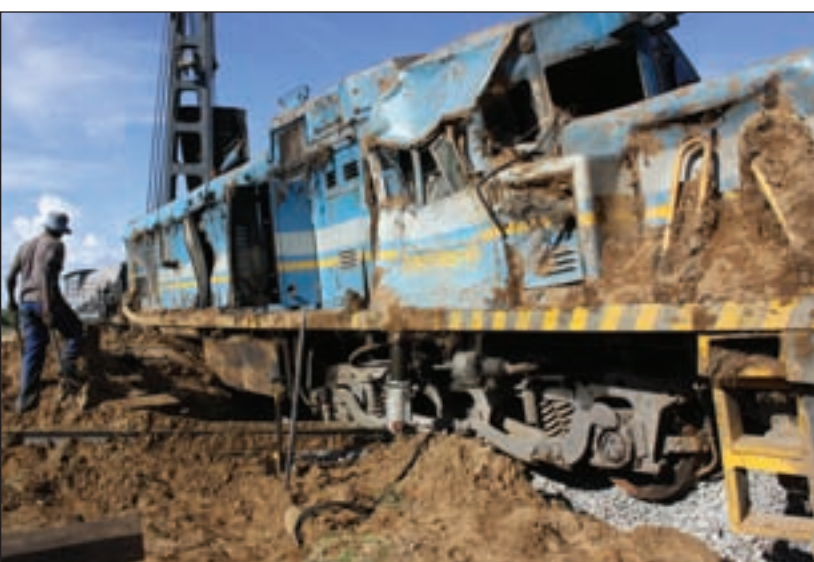
Holger von Hatten (links vorne) verbrachte das vergangene Wochenende an den Hebeln der hydraulischen Wagenheber und in der Kabine des Krans, um vorsichtig die auf der Seite liegende Lokomotive auf die Räder zu stellen und auf Gleishöhe anzuheben. • Fotos: Dirk Heinrich
