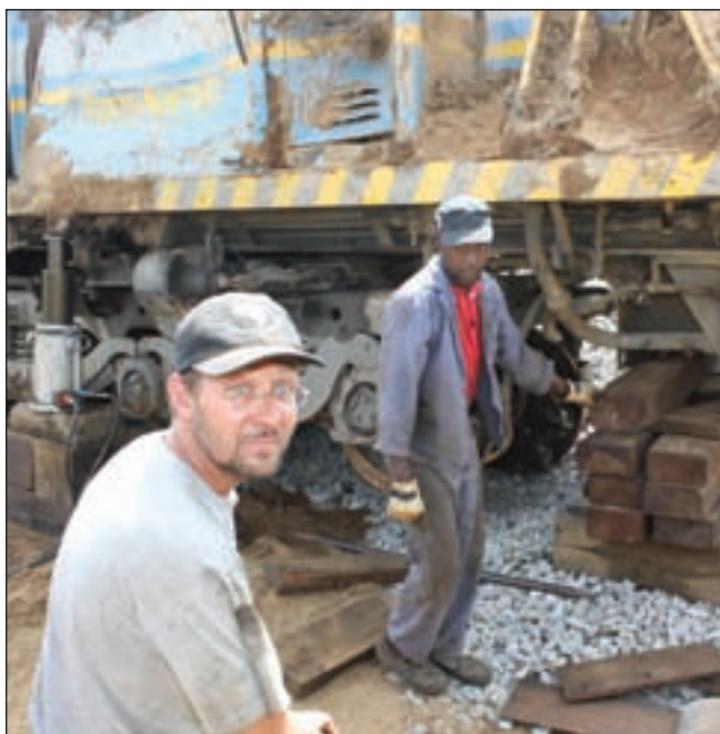
Holger von Hatten (links vorne) verbrachte das vergangene Wochenende an den Hebeln der hydraulischen Wagenheber und in der Kabine des Krans, um vorsichtig die auf der Seite liegende Lokomotive auf die Räder zu stellen und auf Gleishöhe anzuheben. • Fotos: Dirk Heinrich
